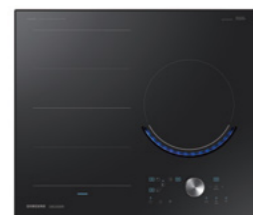
삼성 인덕션 NZ63R9770TG - 화구 : 3구 인덕션(와이드존) - 치수 : W600 × D520 - 타공 : W560 × D480 - 매입깊이 : 75mm ※ 직결 타입
