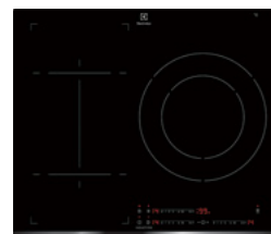
일렉트로룩스 인덕션 CIV60344 - 화구 : 3구 인덕션(와이드존) - 치수 : W590 × D520 - 타공 : W560 × D490 - 매입깊이 : 45mm - 공급처 : 일렉트로룩스(독일)
