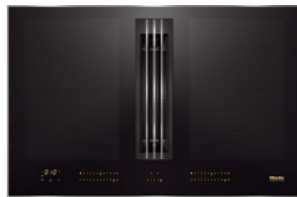
밀레 투인원 쿡탑 KMDA7633FR (후드 + 인덕션) - 화구 : 4구 인덕션 + 매립후드(와이드존) - 치수 : W806 × D526 - 타공 : W780 × D500 - 매입깊이 : 200mm - 공급처 : 밀레(독일) ※ 서랍물통장 / 물통장 사용
