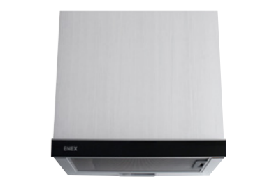
에넥스 슬림 블랙글라스 600 후드 LS-600EG - 치수 : W598×D260-460×H290mm - 필터 : 알루미늄 필터 - 풍량 : 316/206 CMH - 공급처 : 리베첸 ※ 전용장 : CSHX-60/CSHL-60
