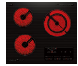
쿠첸 하이라이트 HL3A03FLBE - 화구 : 3구 하이라이트 - 치수 : W580 × D510 - 타공 : W560 × D480 - 매입깊이 : 60mm
