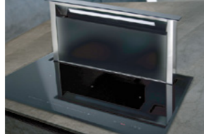
시리우스 다운드레프트 S-DDH2 (후드 + 인덕션) - 화구 : 3구 인덕션 + 다운드레프트 후드 - 치수 : W900 × D510 - 타공 : W860 × D490 - 매입깊이 : 735mm - 공급처 : 시리우스 (이탈리아) ※ W1000이상 물통장 사용
